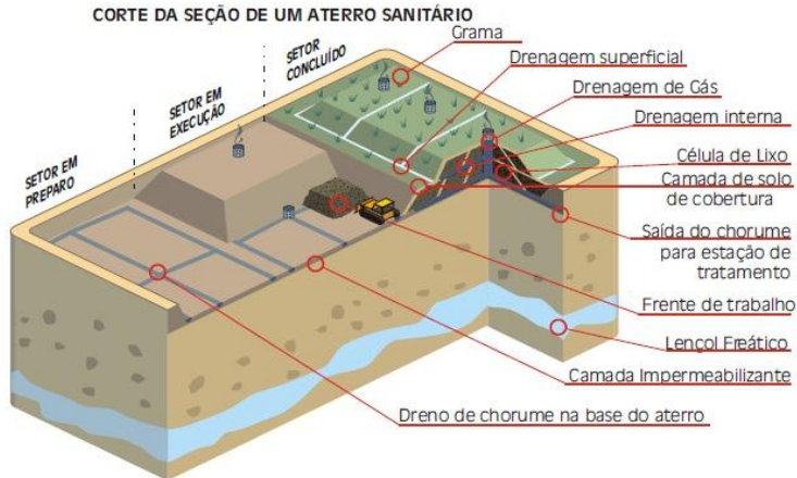
Figura 2: Estruturas de um aterro sanitário
